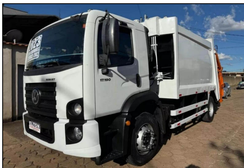
Figura 5 - Foto Ilustrativa Caminhão Compactador
