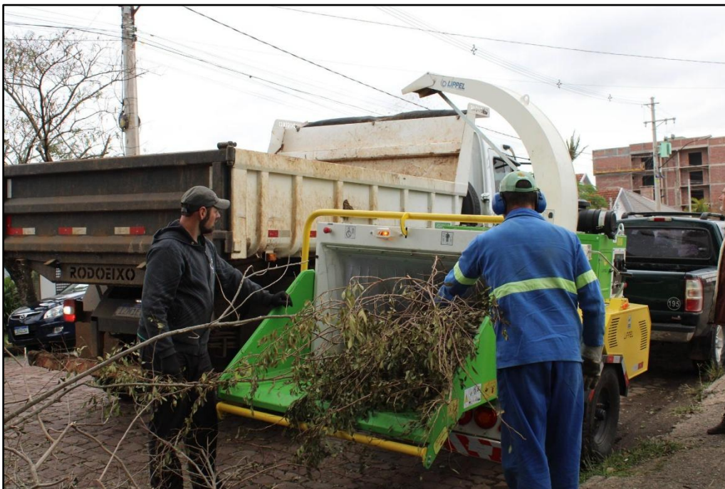
Figura 10 - Processo de Trituração de galhos
